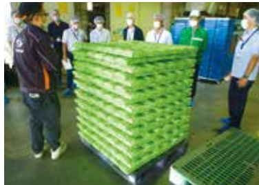
廃棄発泡スチロールのリサイクル工程を見学。写真は、溶融したインゴット
