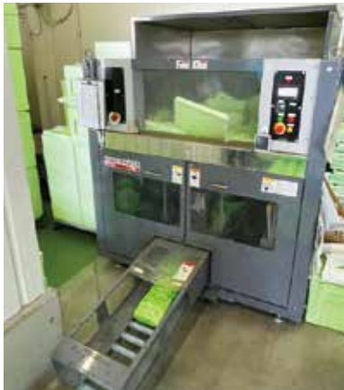
草加要冷蔵センターに設置した使用済発泡スチロールの溶融機
