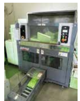
草加要冷セットセンターに設置した使用済発泡スチロールの溶融機
