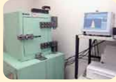
ゲルマニウム半導体核種分析装置 (ゲルマニウム半導体検出器)
