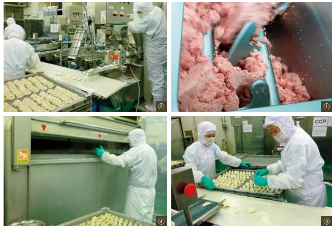
①産直豚肉「かぞの豚」の挽肉を攪拌 ②皮に具を充填し、餃子の形に成形 ③1つ1つ念入りに検品 ④完成した餃子は急速冷凍機で冷凍
